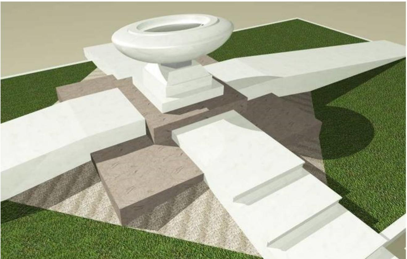
**Immagine 5b.** Esempio tipologico di giardino delle rimembranze (ai lati) più cinerario ossario comune (al centro e sottostanti vani interrati). Quest'ultimi sono accessibili tramite le botole poste nella pavimentazione di colore più scuro (vedi immagine sottostante).
